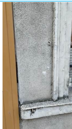
Matériaux : ZPSO-057 Prélèvement : P058 Description : Crépis extérieur Localisation : Rez de chaussée - facade Résultat : Absence d'amiante
