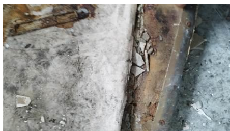
Matériaux : ZPSO-020 Prélèvement : P021 Description : Ragrée Localisation : 3ème étage - sdb 5 Résultat : Absence d'amiante
