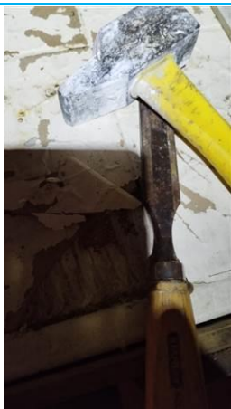
Matériaux : ZPSO-050 Prélèvement : P051 Description : Colle de carrelage plan travail Localisation : 1er étage - séjour cuisine 1 Résultat : Absence d'amiante
